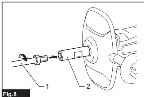
2. Apriete el eje con la llave mientras sujeta el soporte del eje con otra llave.
