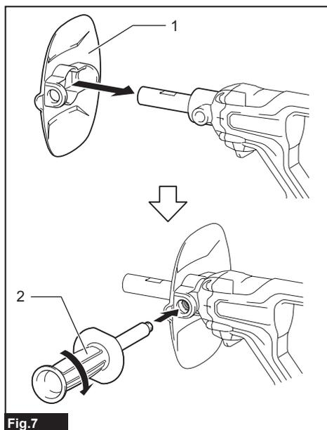
Coloque la cubierta frontal en la herramienta y rosque la empuñadura lateral en la herramienta firmemente. La empuñadura lateral se puede instalar en cualquiera de los lados de la herramienta.
